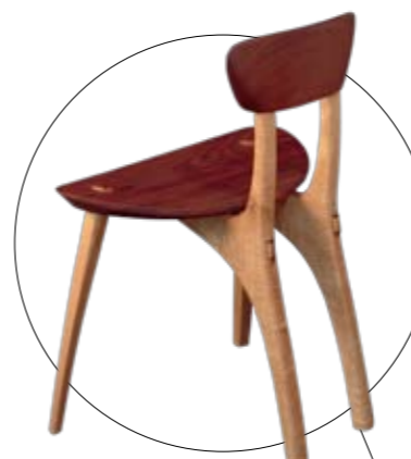
A Cadeira Folha, de pau-marfim e freijó, tem esse nome por causa do desenho do assento. Os encaixes são do tipo ganzape, sem parafusos nem cola, que permitem algum movimento à madeira e evita empenamento
